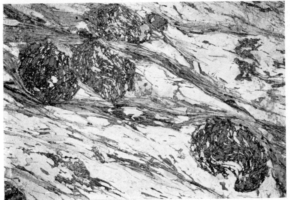
Fig. 26.—(37.151 I.L.M.). Granates rotacionales sin- F_1 de la zona de la estaurolita. N //.
